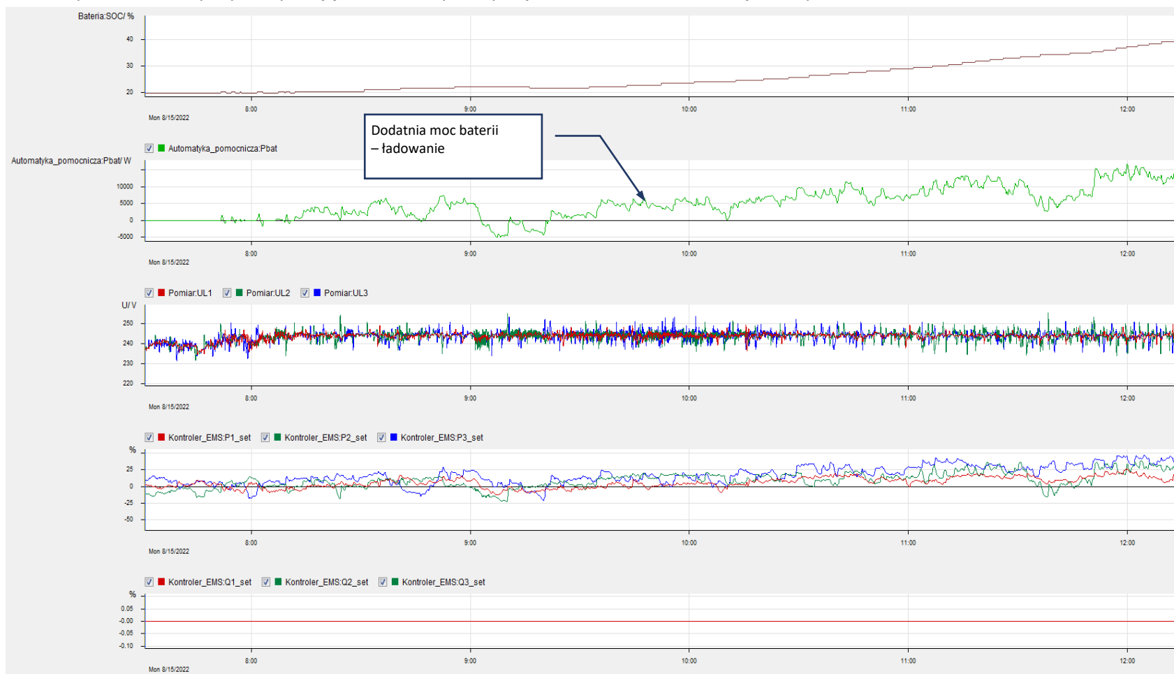
Obniżanie napięcia mocą czynną – fragment rejestracji dobowej z 15-08-2022
